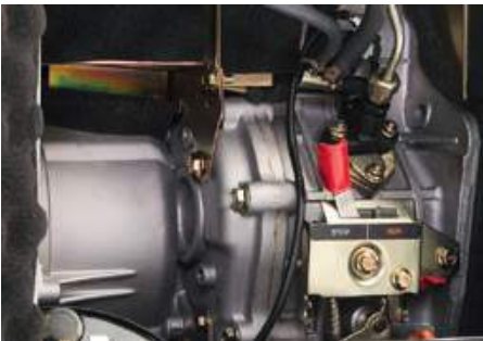
Промышленный коммерческий дизельный двигатель DAEWOO С моторным ресурсом более 2000 моточасов специально разработан для серии генераторов Expert Line.
