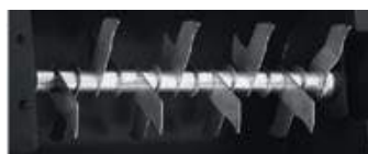
Вал 16 ножей для скарификации
