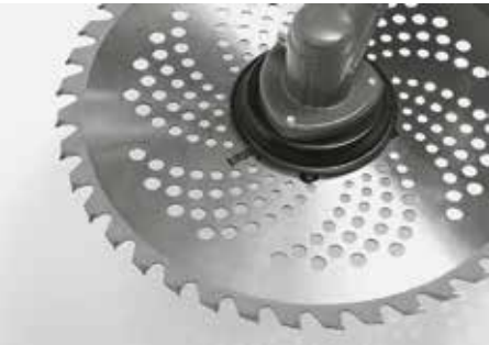
Режущий диск Изготовлен из высокопрочной стали с твердосплавными напайками. 40 зубьев позволяют использовать его для кошения жесткой травы, кустарника и тонких стволов деревьев.
