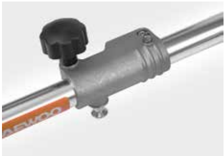
Разъемный алюминиевый вал Позволяет без использования инструментов раз- бирать триммер для компактного хранения.
