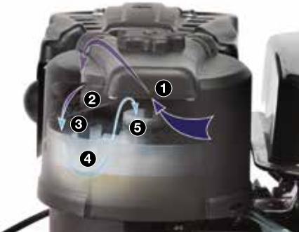
Всесезонный воздушный фильтр 1 Защитная сетка, отсеивающая крупный мусор. 2 Крыльчатка, создающая вихревой поток, отсеивающий частицы пыли среднего и крупного размера. 3 Губчатый фильтр для удаления частиц пыли. 4 Масляная ванночка для сбора оставшейся пыли. 5 2-х слойный фильтр тонкой очистки воздуха.
